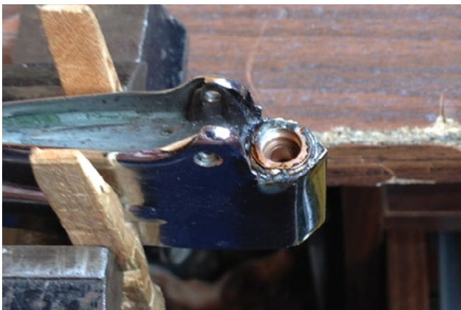
выпаиваем блок клапана из корпуса зажигалки
