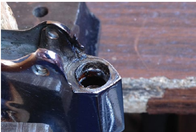
выпаиваем блок клапана из корпуса зажигалки
